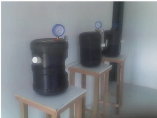
Figura 2. Montaje de los biodigestores
