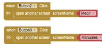
Fig 6. Programación en bloques de nuestro primer prototipo en App Inventor.
