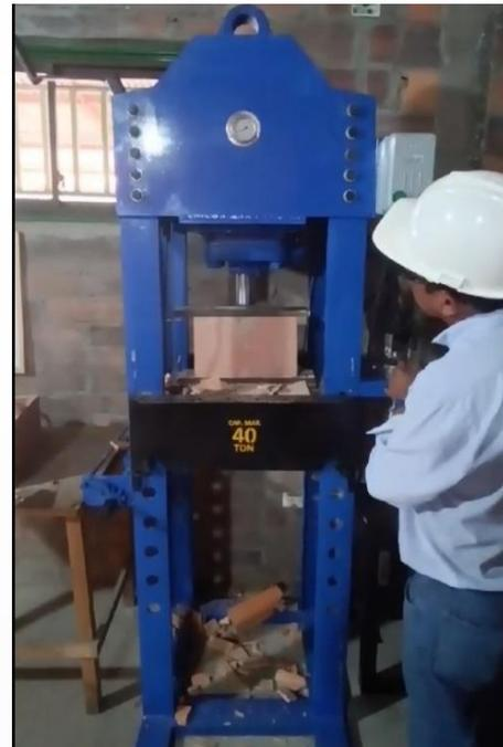
Fig. 5. Prueba realizada a un bloque estructural E-12.
