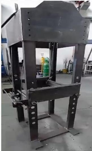
Fig. 4. Fabricación de la estructura del equipo final.
