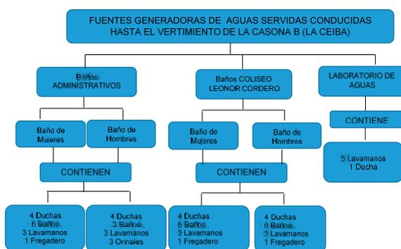
Fig. 1 Fuentes generadoras de aguas servidas conducidas hasta el vertimiento la Casona B (La Ceiba), Unisangil.
