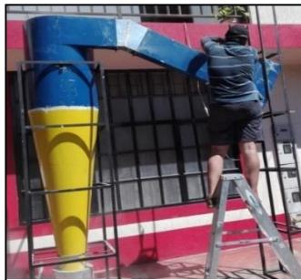
Fig. 9. Prueba ciclón Angulo de 30°.
