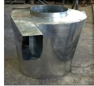
Fig. 3 Corte y doblaje entrada gas.
