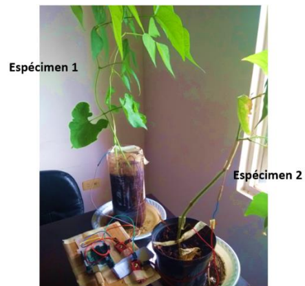
Fig. 11 Montaje utilizado en el segundo experimento utilizando electrodos Ag/AgCl .
