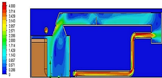
Fig. 4 Gráfico de corte de sección de la velocidad de operación del flujo (agua) en la trayectoria del canal hidráulico abierto.
