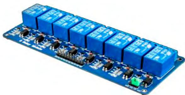
Fig. 3 Placa de relés de 8 canales. [7]
