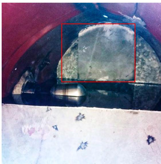
Fig. 4 Adecuación del desviador de entrada- parte interna separador de producción trifásico- recuadro color rojo.
