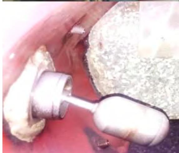
Fig. 6 Controlador neumático (por flotador) encargado de la interfaz del sistema. Separador de producción trifásico.
