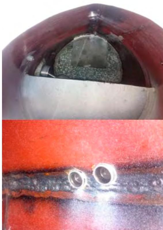
Fig. 7 Adaptación del sensor ultrasónico en la parte interna de la vasija del separador de producción trifásico, compartimiento del aceite.
