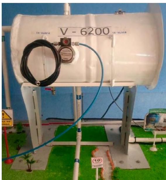
Fig. 3 Separador de producción trifásico horizontal – prototipo propuesto.
