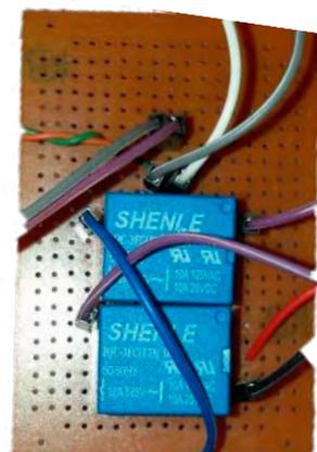
Fig. 11 Circuito de relés para la electroválvula y la bomba sumergible para líquidos.
