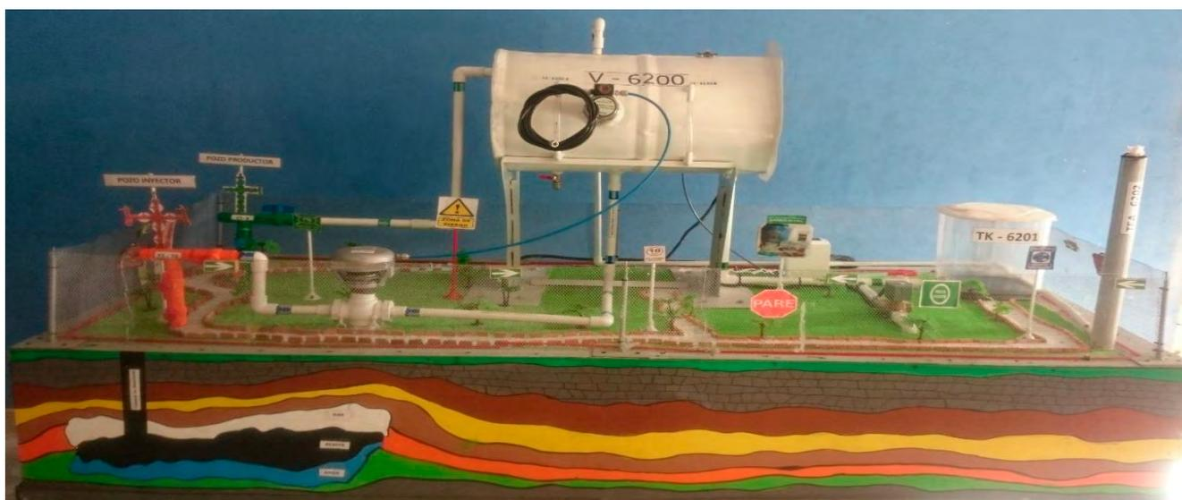
Fig. 12 Implementación sistema de control de un separador de producción trifásico mediante flujo natural, estructura final.
