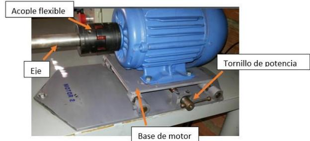
Fig. 13 Sistema de transmisión I.
