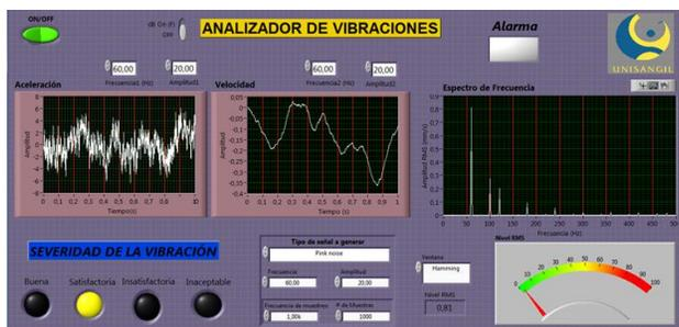
Fig. 12 Interfaz gráfica para análisis de vibraciones.
