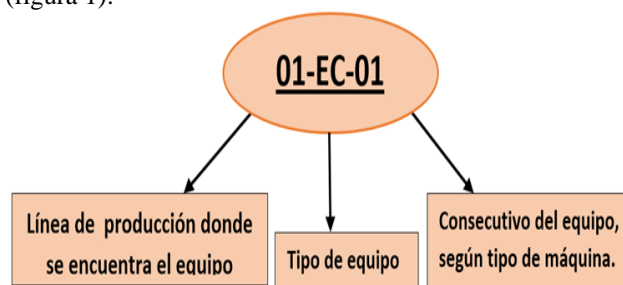
Fig. 1 Codificación de equipos.
