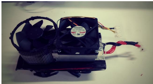
Fig. 2 Cableado conectado en paralelo.
