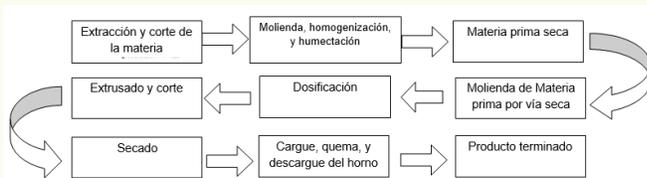
Fig. 1 Diagrama del proceso para la fabricación de ladrillos.
