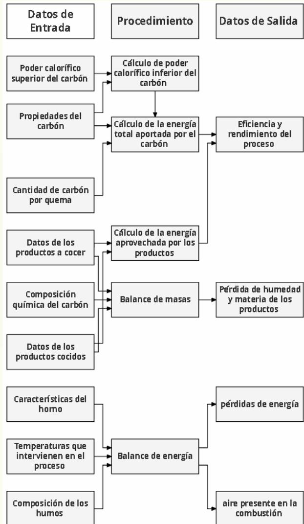
Fig. 2 Flujograma del proceso de cálculos para el balance térmico.
